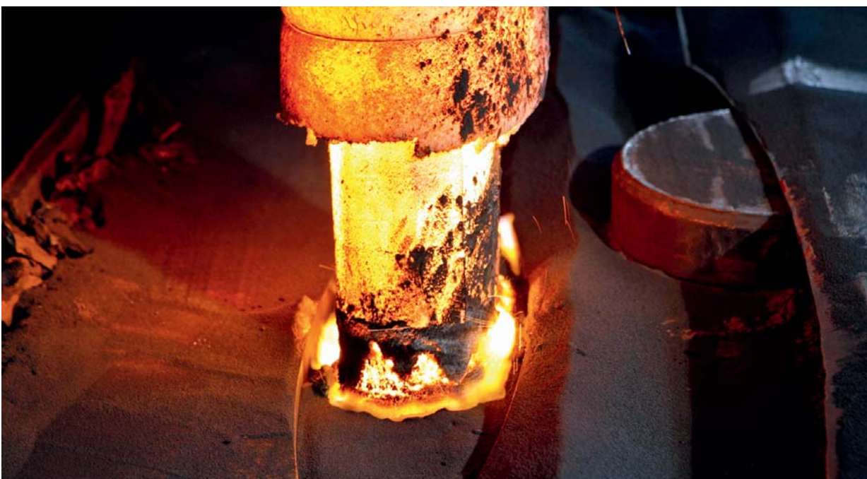
Trichterkokille und Tauchrohr: Herzstück der CSP®-Technologie.
